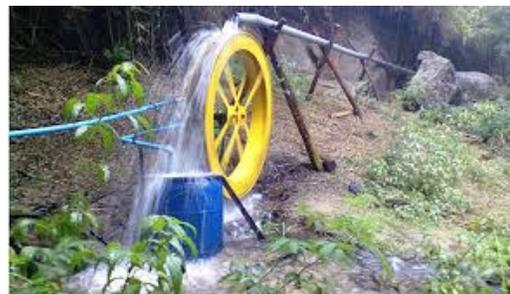
Figura 9: Rueda hidráulica
