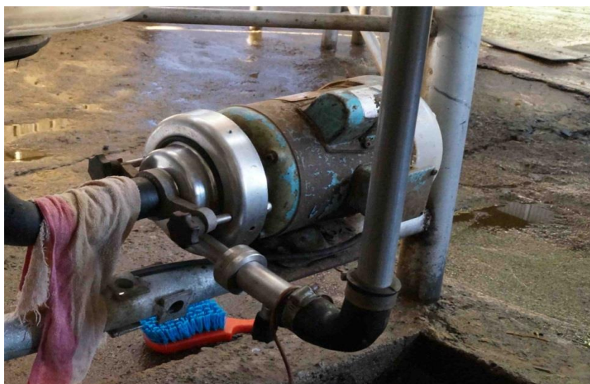
Ilustración 29: Bomba de leche de diafragma sin carcasa de protección
