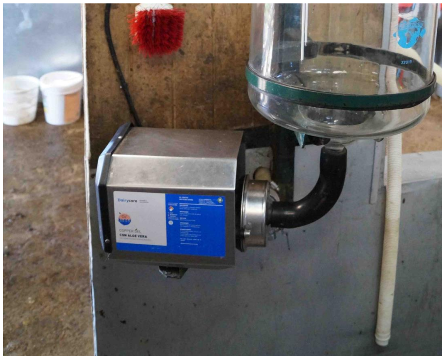
Ilustración 31: Bomba de leche con mantención y carcasa protectora
