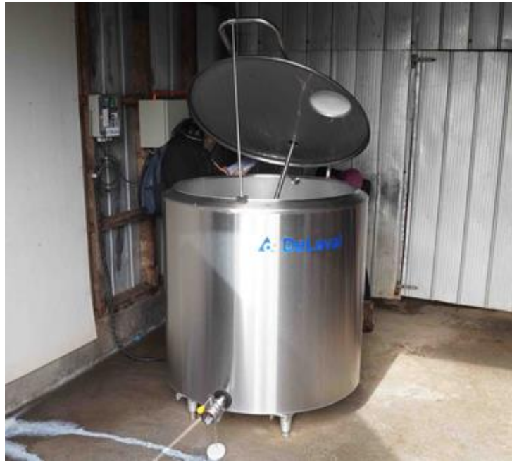
Ilustración 19: Estanque frío de tipo vertical abierto.
