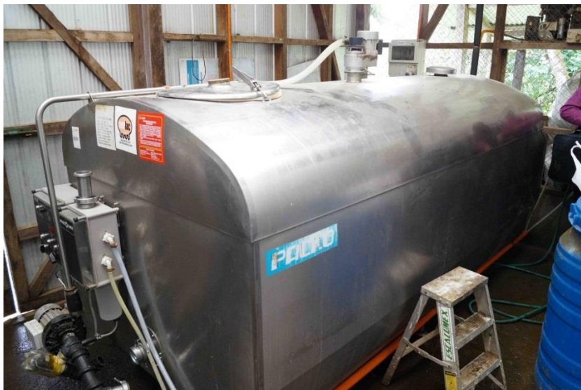
Ilustración 21: Estanque frío horizontal cerrado
